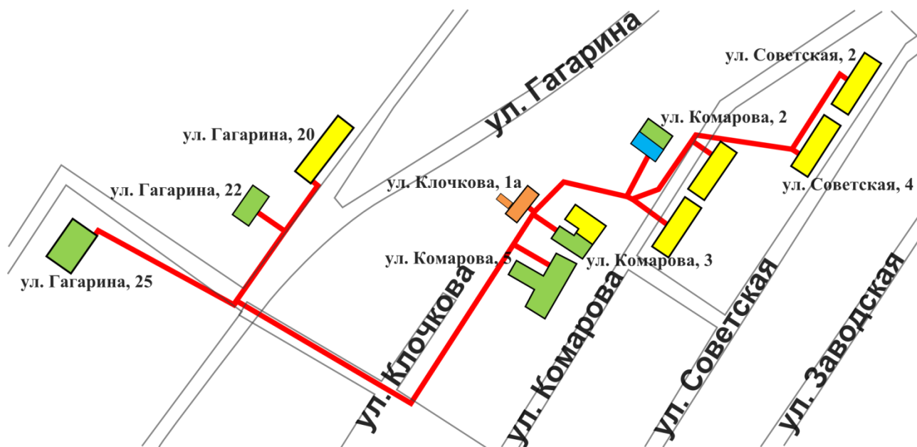
Рисунок В – Карта-схема тепловых сетей МБУ «ЖКХ» в зоне действия котельной п. Ремовский
